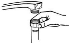
Συνδέστε τον εύκαμπτο σωλήνα τροφοδοσίας κρύου νερού σε σύνδεση με σπείρωμα 3/4(ίντσας) και βεβαιωθείτε ότι είναι σφικτά συνδεδεμένος.
