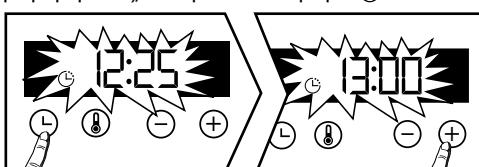
Η ένδειξη αναβοσβήνει. Ρυθμίστε την ώρα τερματισμού μαγειρέματος με τα πλήκτρα + ή -. Η αποθήκευση της ώρας τερματισμού του μαγειρέματος πραγματοποιείται αυτόματα σε μερικά δευτερόλεπτα. Η ένδειξη τερματισμού μαγειρέματος σταματά να αναβοσβήνει.
