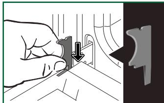
Αφαιρέστε το πρώτο περικομένο παράθυρο: πατήστε χρησιμοποιώντας ένα εργαλείο (κατσαβίδι) στις θέσεις (A) για να ξεκουμπώσετε το παράθυρο και αφαιρέστε το.
