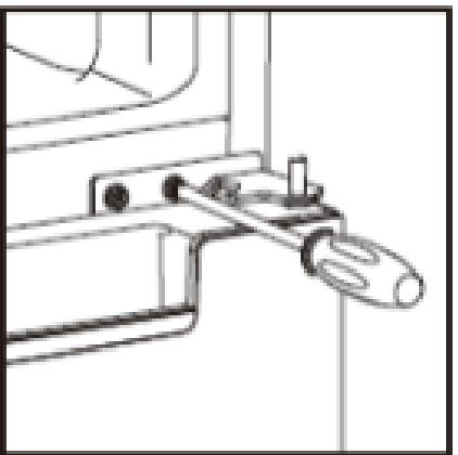
4. Τοποθετήστε το ψυγείο σε οριζόντια θέση, αφαιρέστε τα ρυθμιζόμενα ποδαράκια, και, στη συνέχεια, αφαιρέστε το κάτω μεντεσέ με σταυροκατσάβιδο
