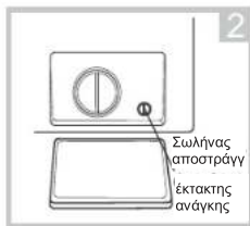
2 Περιστρέψτε κατά 90°C, τραβήξτε έξω τον σωλήνα αποστράγγισης έκτακτης ανάγκης και αφαιρέστε το καπάκι του σωλήνα
